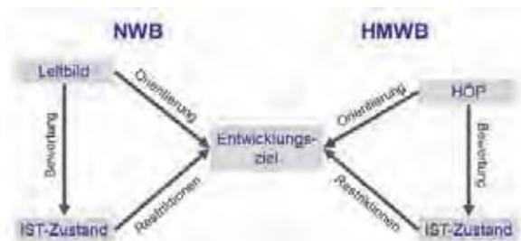
Abb. 9: Schema zum planerischen Vorgehen zur Herleitung von Maßnahmen an natürlichen (NWB) und erheblich veränderten Wasserkörpern (HMWB)
