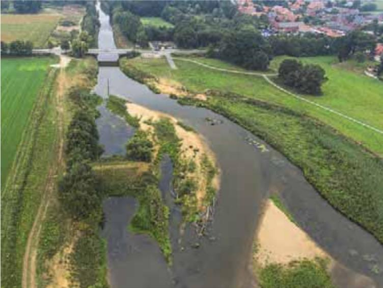
*Renaturierung der Ems oberhalb der Brücke Eimen mit breit gestalteter Sekundäraue (links im Bild der frühere Verlauf mit Querabdämmung, im Hintergrund die noch ausgebaut Ems)*
