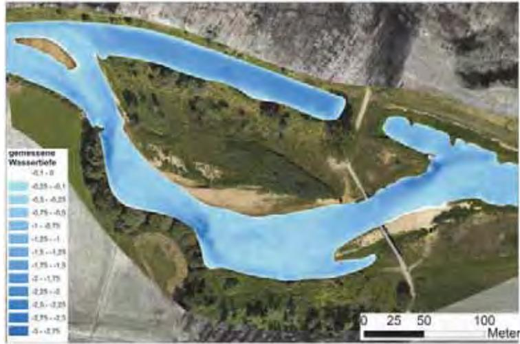
*Ergebnis der Auftrag-/Abtraganalyse im Bereich der Lonnbrücke im Vergleich der Echolotvermessungen 2011 und 2012*
