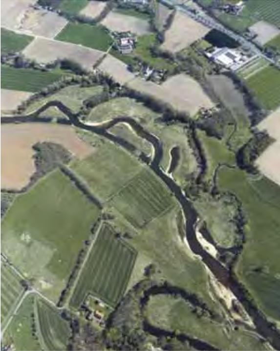
Abb. 3: Luftbild der Ems bei Einen mit zwei Initialgerinnen und schlafender Sicherung (Bildmitte), Laufrichtung von links oben nach rechts unten (Foto: Mantel)
