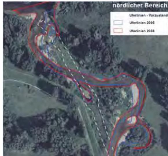
Abb. 2: Vorzustand und eigendynamische Entwicklung der Uferlinien nach der Renaturierung der Indemündung bei Kirchberg (nördlicher Bereich, aus WVER 2009)
