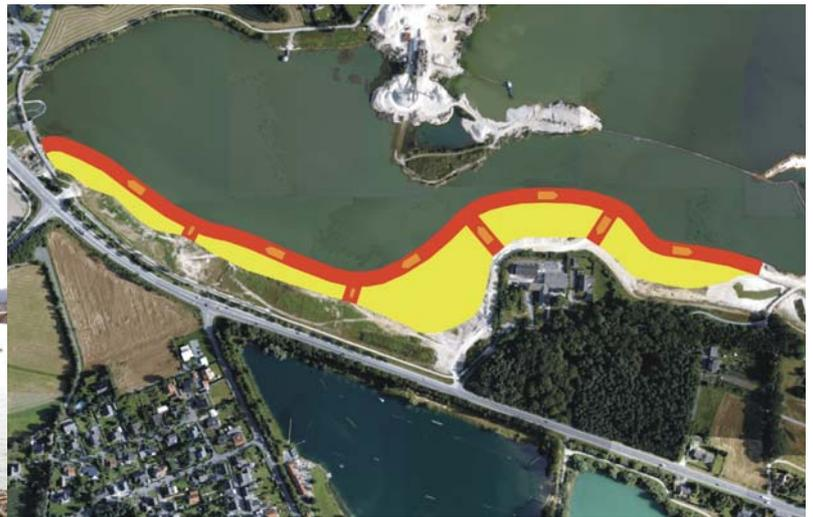
Der Damm wurde aus Sicherheitsgründen mit einer Kronenbreite von 15 m bis ca. 1 m über Seespiegelniveau geschüttet. Das Material wurde vor der Wasserlinie abgekippt und mit einer Raupe in den See geschoben.
