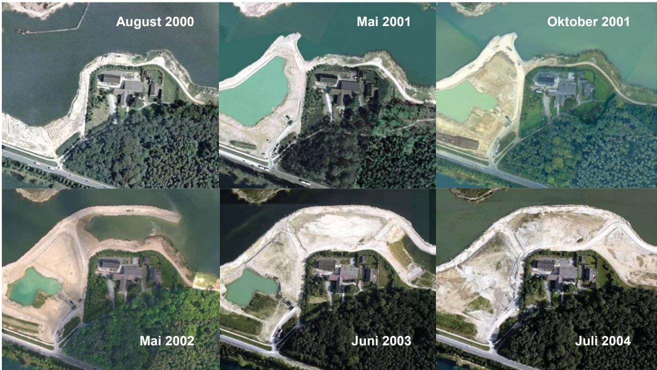
Markierung und Orientierung eines Trassenverlaufes auf einer offenen Wasserfläche sind schwierig. Die Einmessung des Baufortschrittes der Vorschüttung wurde mittels GPS (Global Positioning System) durchgeführt. Eingesetzt wurden ein 12-Kanal-Empfänger mit Langwellenzusatzdecoder sowie ein hochpräziser Satellitenempfänger, der mittels eines Mobilfunk-Korrektursignals Lagegenauigkeiten von  $\pm 1$  cm und Höhengenaugigkeiten von  $\pm 2$  cm liefert.
