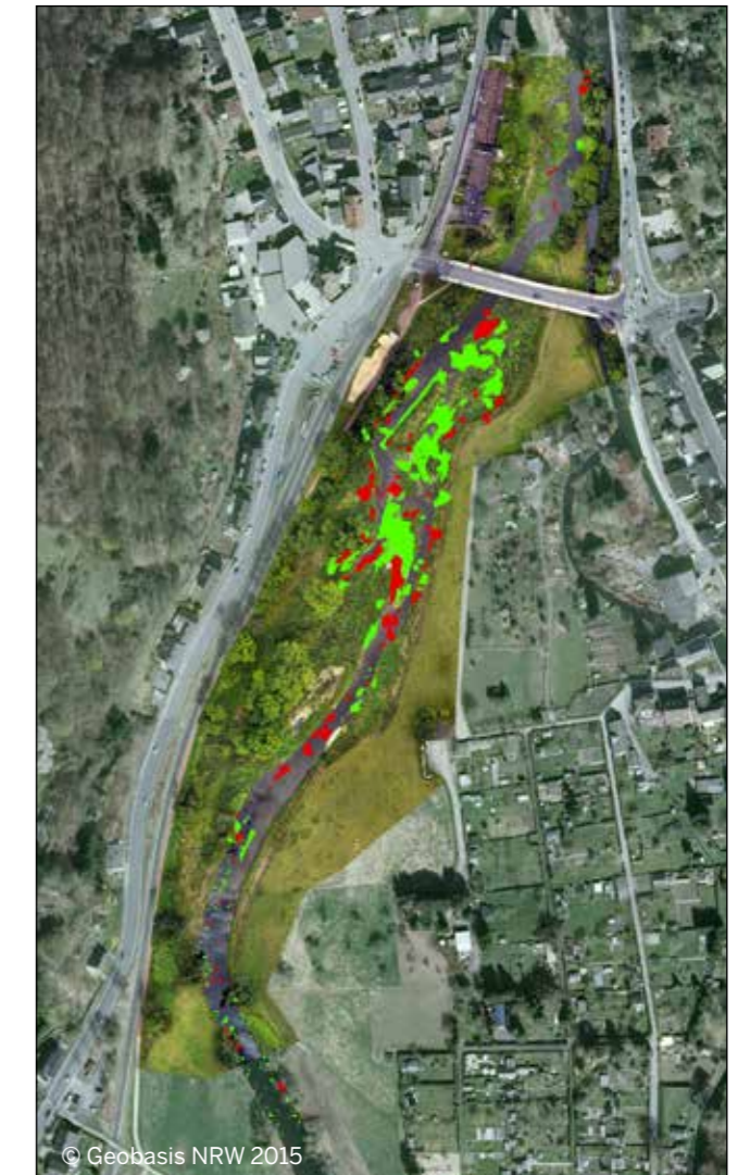
Aufträge und Abträge von Kies und Schottern im Vergleich der Jahre 2013 und 2014, grün = Flächen mit Auflandungen, rot = Flächen mit Materialabträgen
