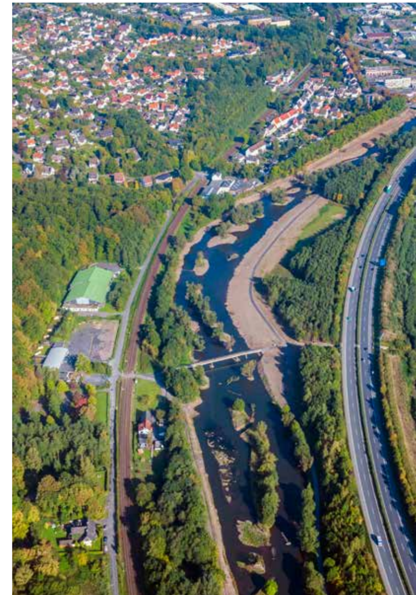
Unten: Aus der Luft wird deutlich, wie zwischen Bahnlinie und Autobahn der Fluss verbreitert und die Ruhraue wieder geöffnet wurde.
